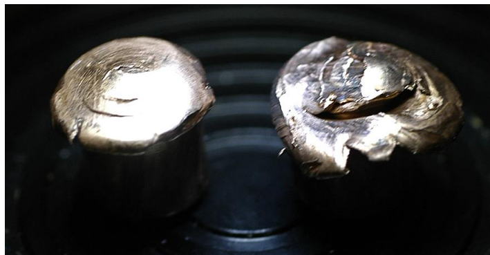
Esquerre: projectil impactat sobre superfície tova. Superior: projectils impactats sobre superfície dura. La deformació la marcarà la superfície d'impacte.
