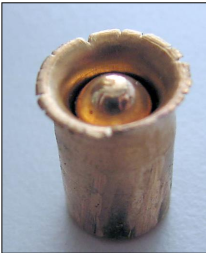
Esquerre: projectil impactat sobre superfície tova. Superior: projectils impactats sobre superfície dura. La deformació la marcarà la superfície d'impacte.
